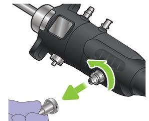
Retirez le **testeur d'étanchéité**.
