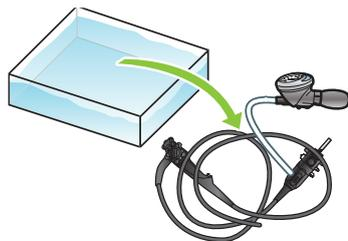
Retirez l'endoscope avec le testeur d'étanchéité fixé, puis placez-le sur une surface plane.
